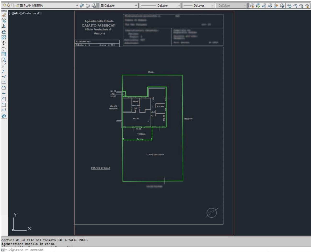
Ad esempio, facendo doppio click sull'immagine della planimetria, abbiamo la scheda planimetrica con sovrapposte le Tipologie di ambiente (poligoni DocFa) nel nostro CAD e con l'immagine perfettamente in scala!
